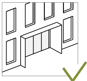
Входная группа утоплена в фасад
